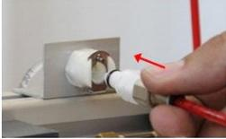
Para desconectarlos simplemente presionar la pieza metálica que hay en la parte superior del enchufe.
