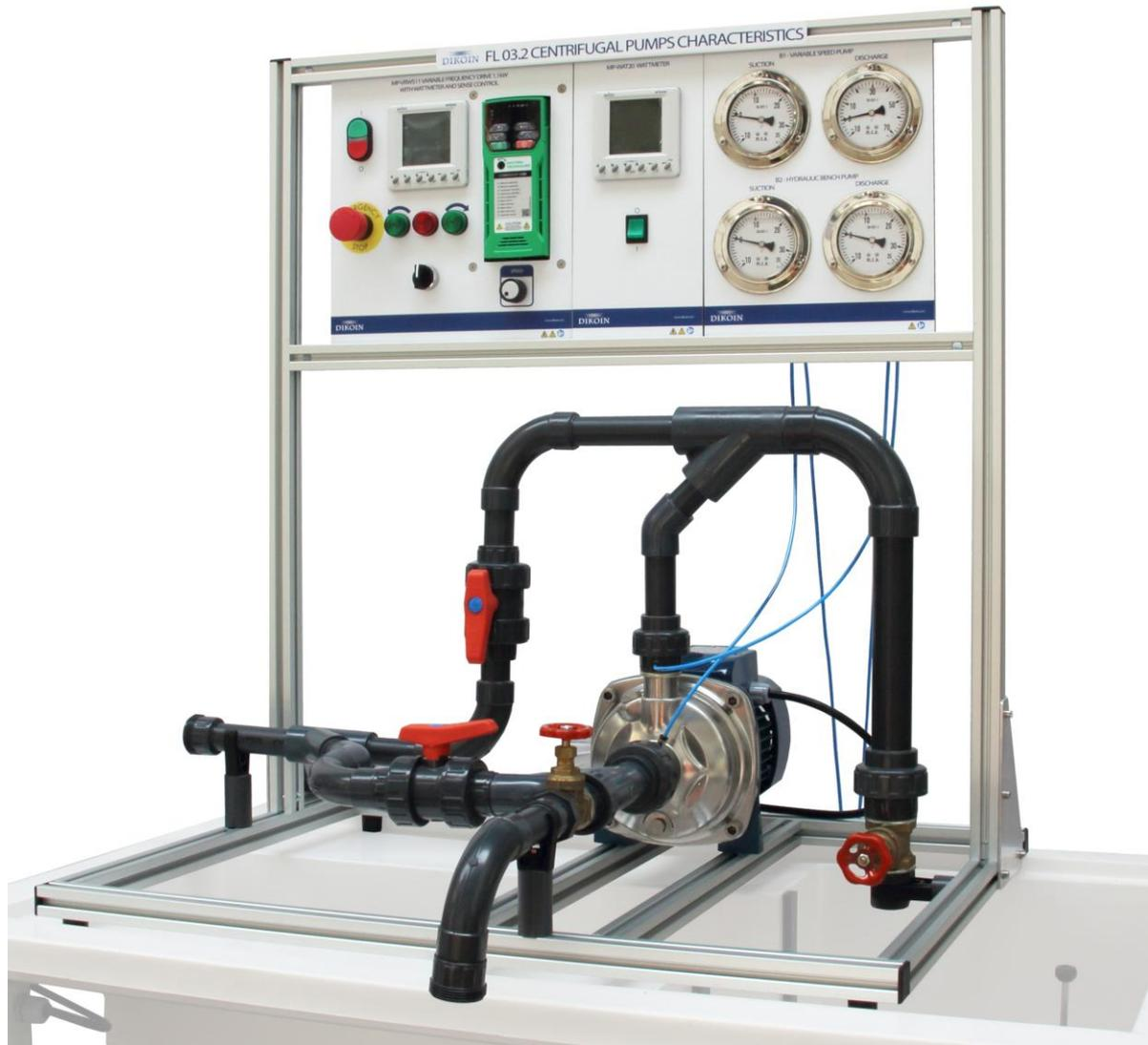
El equipo está diseñado para funcionar sobre el banco hidráulico. La instalación va montada sobre un marco construido con perfiles de aluminio, contando con un sistema de tuberías y válvulas que permite que se puedan acoplar la bomba del banco hidráulico y la del equipo tanto en serie como en paralelo.
